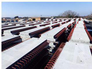
PC床版とは、橋軸直角方向にプレストレス構造を用いたプレキャスト床版です。
