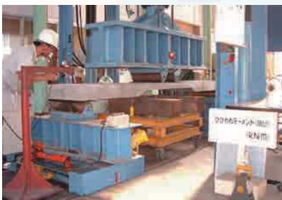
□単体曲げ試験(薄肉部構造形式選定)
