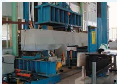
□複合部材曲げ試験(裏込め材選定)
