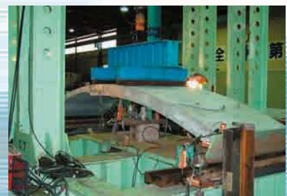
□円弧梁試験(部材接合部性能確認)
