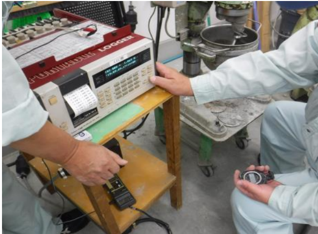
粉体のキャピラリー状態に必要な水粉体比の試験 (トルク試験)
