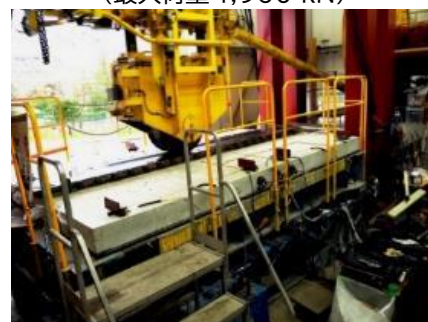
輪荷重走行疲労試験 (最大荷重 490 kN)
