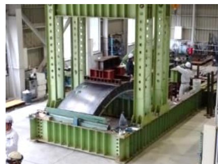
門型荷重試験台〔円弧試験体曲げ試験〕 (最大荷重 1,960 kN)
