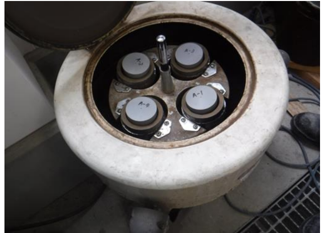
細骨材の表面吸着水率試験 (遠心試験)
