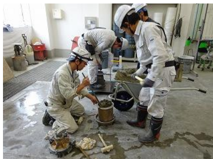
コンクリートの配合(調合)選定試験 〔スランプ、空気量など〕
