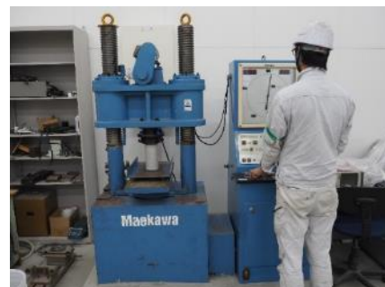
圧縮強度試験(最大荷重 2,000 kN)
