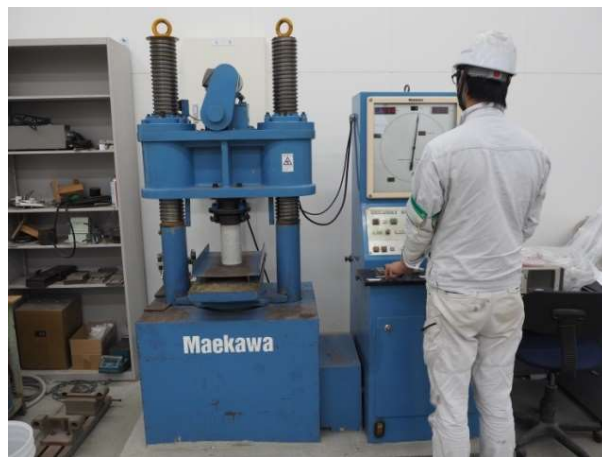
圧縮強度試験機 (最大荷重2,000kN)
