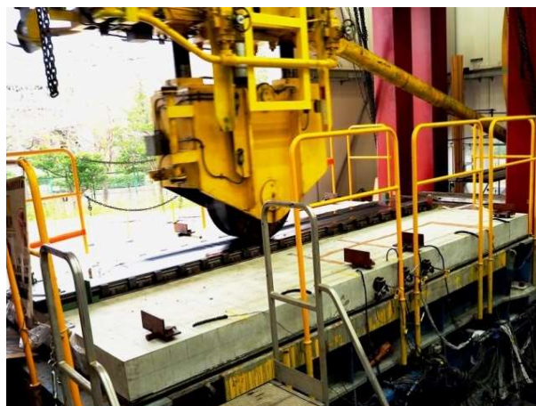
輪荷重走行疲労試験(最大荷重490kN)
