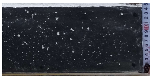
棒状バイブレータ使用側面
