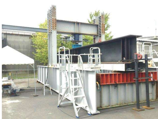
負曲げ載荷試験 (門型載荷試験台 最大荷重3,920kN)
