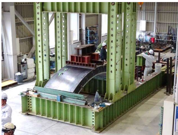
円弧試験体曲げ試験 (門型載荷試験台 最大荷重1,960kN)
