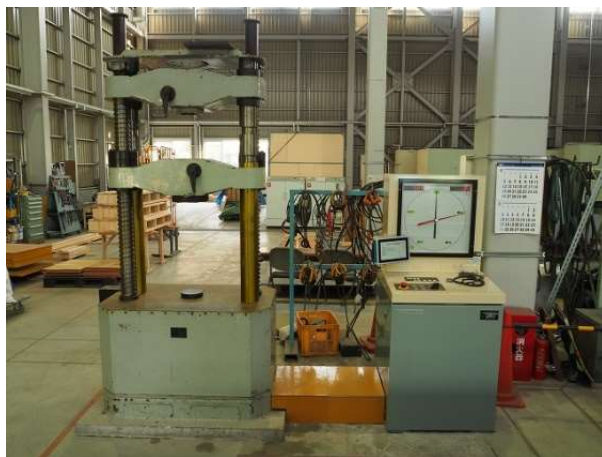
万能試験装置 (最大荷重1,000kN)
