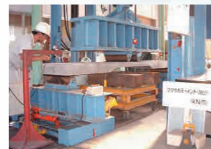
□単体曲げ試験（薄肉部構造形式選定）
