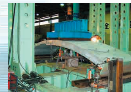
□円弧梁試験（部材接合部性能確認）
