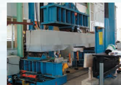
□複合部材曲げ試験（裏込め材選定）
